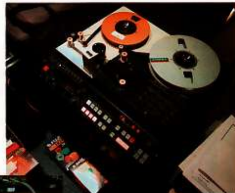
Een professionele videorecorder voor het 1 inch Ampex-systeem, zoals die begin jaren tachtig bij de omroepen in gebruik was.
